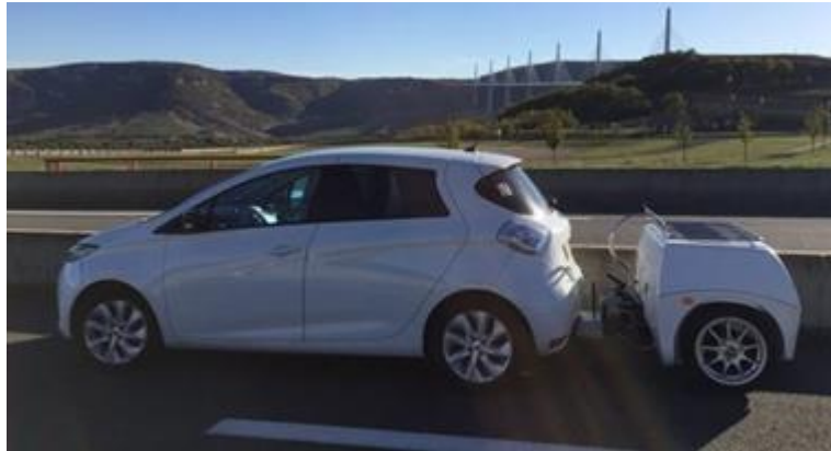
Figure 1 : Exemple de batterie sur remorque : EP-Tender 1
